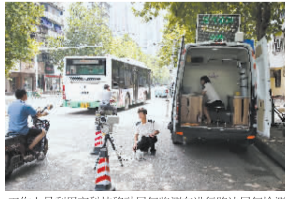
工作人员利用高科技移动尾气监测车进行路边尾气检测
